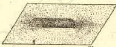
Fig. 4.—Un solenoid prin o foaie de hîrtie
