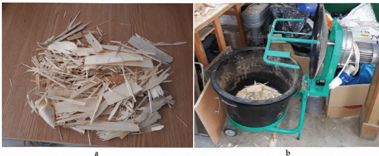
Figura 4. Așchii utilizate în tehnologia OSB (a) și malaxor pentru amestecul așchiilor cu adeziv (b)
