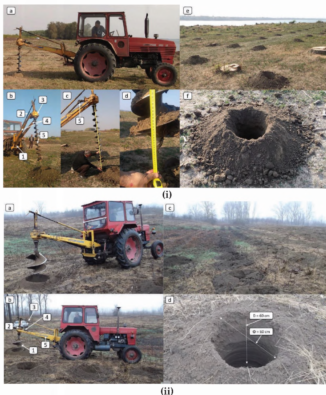
Figura 1. Descrierea echipamentelor utilizate, a operațiilor realizate și a dimensiunilor gropilor. Legendă: (i) gropi pentru sade: a – agregatul folosit, b – detalii ale mașinii de săpat (1 – cadru, 2 – dispozitiv de ajustare, 3 – corpul mașinii; 4 – cadru lateral; 5 – burghiu), c & d – detalii ale sistemului de transmisie și ale burghiului, e – imagine de ansamblu a suprafeței după operare, f – groapă pentru sade; (ii) gropi pentru puieti: a – agregatul folosit, b – detalii ale mașinii de săpat și ale burghiului (1 – burghiu, 2 – corpul mașinii, 3 – dispozitiv de ajustare; 4 – sistem de transmisie; 5 – cadru lateral), c – imagine de ansamblu a suprafeței după operare; d – elementele dimensionale ale unei gropi
