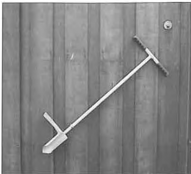
Foto 5. Unealtă simplă concepută și produsă de către LIECO pentru plantarea puieților containerizați
