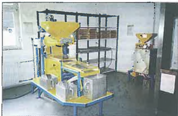
Fig. 2. Mașini pentru sortarea semințelor de rășinoase (molid și larice)
