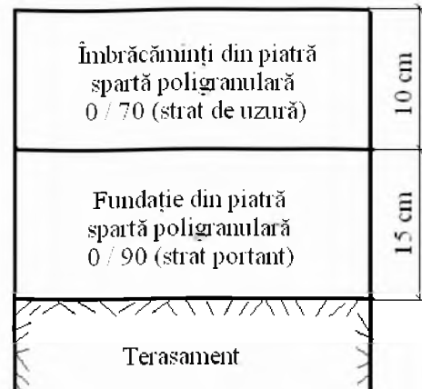
Fig. 2. Variante de structuri rutiere și parametri de calcul, în ipoteza de trafic de 1.000 - 3.000 t/an
