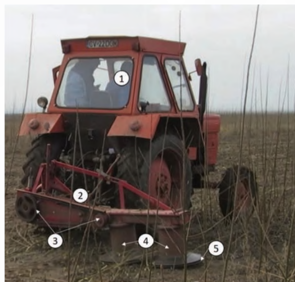
Fig. 8. Alcătuirea agregatului tractat pentru tăieri de lăstărire. Legendă: 1 - tractor, 2 - agregat pentru execuția tăierilor de lăstărire, 3 - transmisie mecanică, 4 - dispozitive de tăiat, 5 - fanta cuțitelor de tăiat
