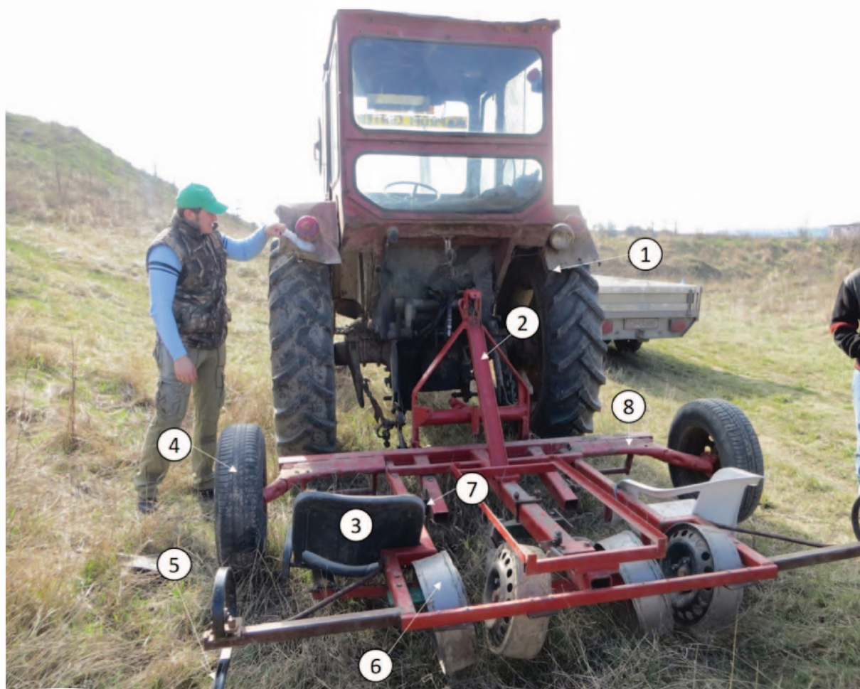
Fig. 5. Alcătuirea agregatului de plantat. Legendă: 1 - tractor, 2 - cuplaj mecanic pentru tracțiune și ridicare-coborâre, 3 - scaun pentru operatorul manual, 4 - roată de susținere a cadrului, 5 - dispozitiv de marcarea a fâșiei de plantat (plantate), 6 - rolă metalică de închidere a șanțului de plantare, 7 - sapă cu rol de dislocator, 8 - cadrul metalic al dispozitivului de plantat.
