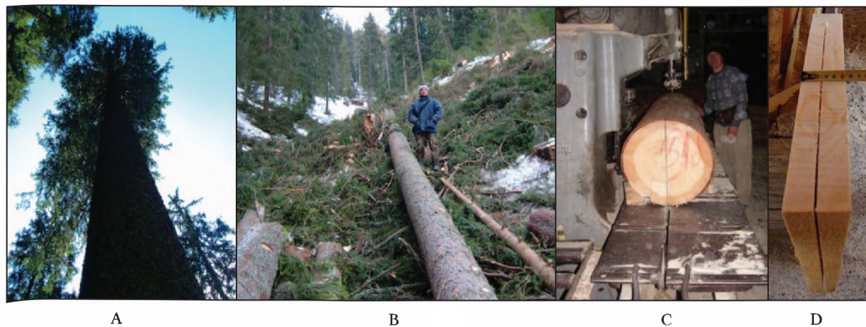
Fig. 2. Lemnul de rezonanță pe traiectoria valorificării: A. arbore de molid de rezonanță pe picior; B. catarg de molid de rezonanță; C. operație la debitarea bușteanului (spintecarea cu ferăstrăul panglică); D. semifabricat de vioară
