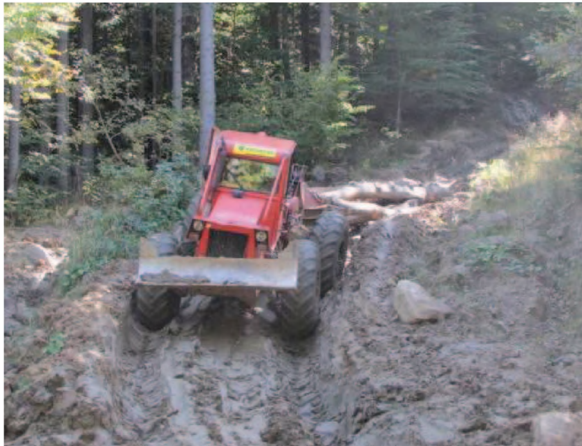
Foto 6. Efectele asupra drumurilor din pădure în urma scoaterii lemnului cu tractoarele forestiere articulate (Foto dr. C. Dolocan)
