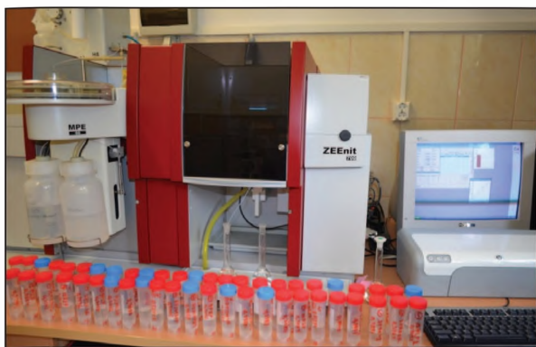
Fig. 5. Instantaneu cu spectrometrul de absorbție atomică ZEE nit 700 în timpul efectuării determinărilor analitice
