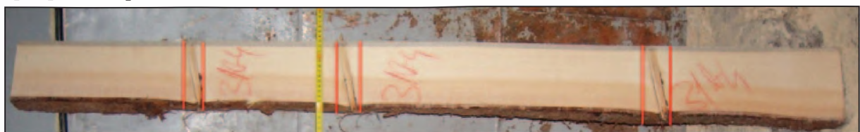
Fig. 6. Piesă de cherestea brută de rezonanță (cu roșu - nodurile identificate)
