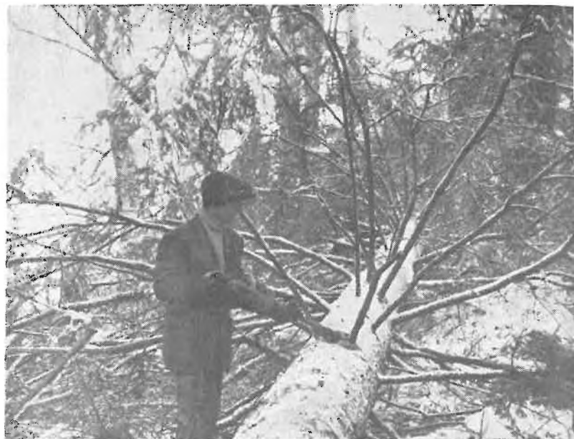
Fig. 2. Curățirea de crăci cu ajutorul cepui-torului sovietic RES 1 se face rapid și cu efort minim.
