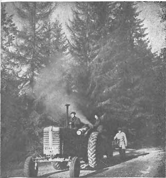
Fig. 3. Dăunătorii pădurilor sînt combătuți cu mare eficiență și pe cale chimică, prin prăfuire cu insecticide, cu ajutorul prăfuitoarelor mecanice.
