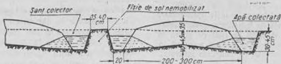
Fig. 8. Bilonare cu șanțuri colectoare duble — executate cu plugul.
