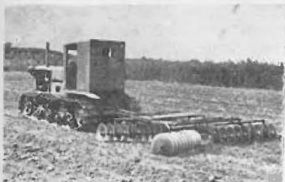
Fig. 1. Prelucrarea mecanizată a solului prin discuire la stațiunea experimentală Miciurin a I.C.F.
