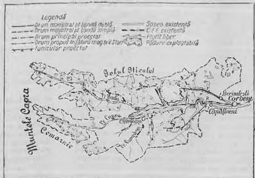
Fig. 4. Schema instalațiilor de transport din MUF8 Argeșul Superior.
