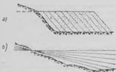
Fig. 3 - Așezerea cu buldozerul a pămîntului în rambleu.
