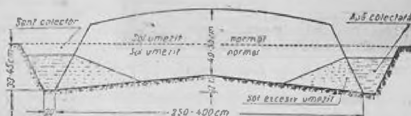
Fig. 4. Secțiune transversală trapezoidală printr-un bilon.
