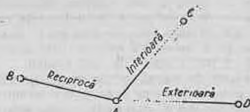
Fig. 3. Notarea vizelor în raport cu un punct.
