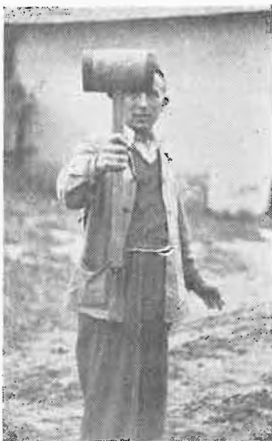
Fig. 3: Mal de bățut parii pe care se fixează plasa (foto H. Almășanu).
