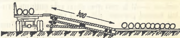
Fig. 2. Rampa mobilă simplă pe capre „în rampă”.
