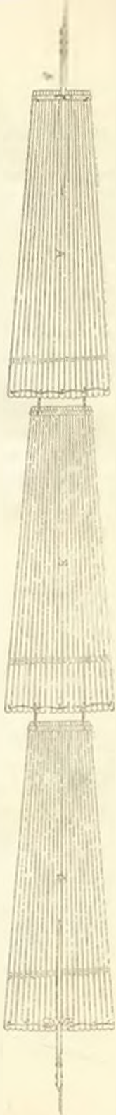
Fig. 12. — Modul de așezare a cirnei la capătul de dinapoi și sistemul de legat a lemnelor.
