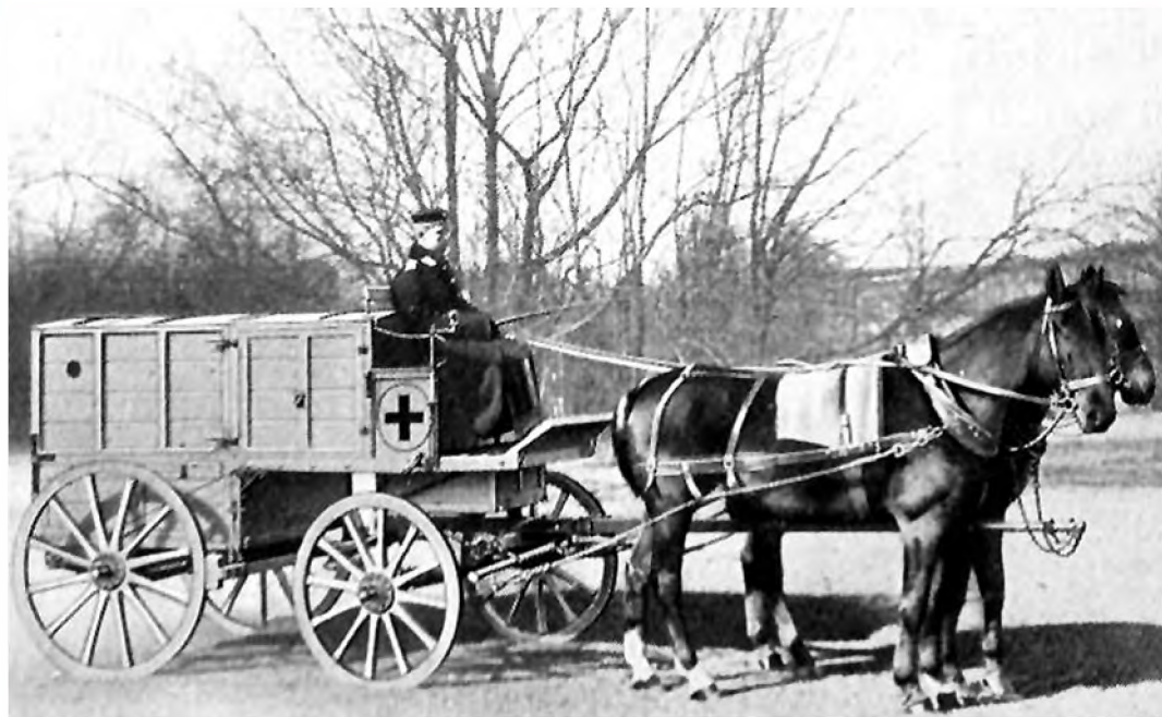
Vehicule de teren cu raze X (Veifa/Siemens & Halske). De Rudolf Grashey (ed.), Roentgen, Leipzig 1922 (Manualul experiențelor medicale în războiul mondial 1914/1918, editat de Otto von Schjerning, vol. IX), p. 15,16.
