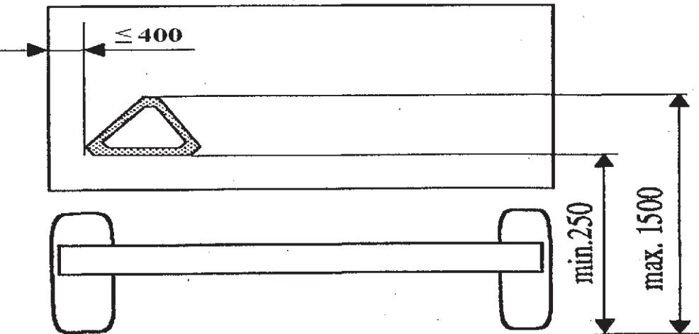
(7) Placa de identificare trebuie montată cu cuvântul "TOP" înscris orizontal pe partea superioară a plăcii (dacă există acest marcat). Placa de identificare trebuie montată pe o suprafață perpendiculară pe axa longitudinală a vehiculului (înclinarea unghiulară maximă nu va depăși  $5^{\circ}$  pentru nici o parte a plăcii), iar marginea sa inferioară trebuie să fie paralelă la sol.
