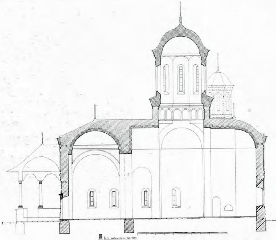
Fig. 11 bis. — Vederea bolților interioare după restaurare.
