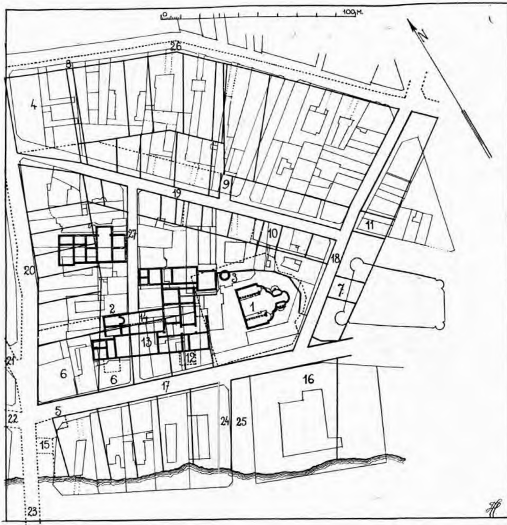
Fig. 1. — Curtea Veche din București, după planul din 1799: 1. Biserica Domnească, cu trei altare; 2. Paraclisul, din Palatul Domnesc; 3. Baia cu cuptor subteran, găsită în săpături dar nefigurând în plan; 4. Parcela pe care se afla baia din Curtea Veche; 5. Poarta din sus, cu foisor; 6. Parcellele cumpărate de Vornicul Goleacu, pe care a făcut Hanu Roșu: clădirea, în forma de U se găsește în planul Boroczyn din 1852; 7. Altă parcelă cumpărată de același; 8. Zidul despre dosul Șelarilor; 9. Loc de 3 stânjieni lăsat pentru uliță nouă în colțul despre zidul pușcăriei; 10. Parcela cumpărată de Ilie, vâtaful de pușcărie; 11. Polcul de Vânători; 12. Pridvor de intrare în Palat, ce nu figurează decât în planul din 1791; 13. Sala mare; 14. Sala mare susținută la mijloc de un rând de colțane; 15. Cămineonul lui Altântop în 1801; 16. Parcela pe care s'a construit o parte din Hanul Manuc; 17. Podul prin Curtea Veche, larg de 8 m, Podul dela Curtea Veche în 1804, Ulița Curtea Veche în 1852, actuala strada Carol; 18. Podul nou, larg de 6 m; Ulița Șepcari în 1852; 19. Podul nou, larg de 5,50 m; Ulița Covaci în 1852, actuala strada Oituz; 20. Podul spre Mihel Beceriu, larg de 8,50 m; Pod ce merge spre Șelari în 1804; Ulița Șelari în 1852; Ulița lui Ccstandinache în 1825; 21. Fără nume în planul din 1799; larg de 6 m, Podul ce merge dela Curtea Veche spre Hanul lui Șerban-Vodă în 1804; Ulița Nemțească în 1852; strada Germană în 1876, actuala strada Smârdan; 22. Fără nume în planul din 1799, larg de 8 m; Boiangii și Ișlicari în 1804; Ulița Franțuzească în 1852, actuala strada Carol; 23. Podul spre Dcamna Bălașa, larg de 8 m; 24. Drumul Sacagiilor, larg de 6 m; Vadul Sacagiilor în 1804; fără nume în planul din 1852, dar cu pod de trecere peste apă; actuala strada Căldărari (25); 26. Ulița în desul Șelarilor, largă de 6 m; Fără nume în planul din 1852, actuala strada Gabroveni; 27. Ulița la binale, largă de 5,50 m, prelungită, fără nume, până în strada Carol, înainte de 1852, actuala strada Soarelui.
