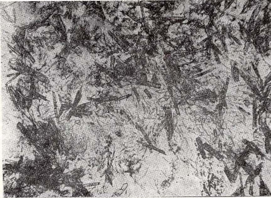
Fig. 6 — Grès quartzeux à l'illite/muscovite sur des fissures et en nids. Pregheda-Banat, lame mince, N +, \times 100 .
