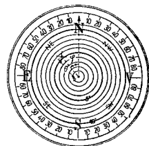
Diagrama de înregistrare fotografică a înclinării și orientării găurii de sondă. φ) azimutul înclinării; θ) unghiul de înclinare.
