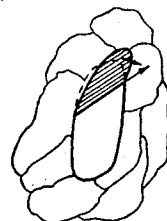
XVI. Reprezentarea schematică a deformării unui cristallit, la întinderea unei epruvete policristaline (direcția de întindere e considerată verticală).
