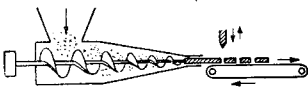
Mașină combinată de extrudat cu șurub-melc, de tăiat calupuri (cu cuțit) și transportat materialul.
