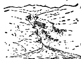
Fig. 582 bis - Un torent. M - bazinul de recepție. T - canalul. C - loc de dejecție
