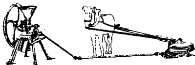
Fig. 1088. — MANEJ PUNÂND IN MIȘCARE O TOCĂTOARE DE FÂN.
