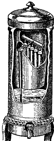
2 Fig. 831. — FILTRU CHAMBERLAND fără presiune, cu mai multe bujii.
