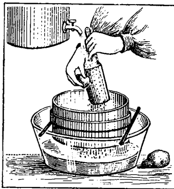
Fig. 772. — PRINCIPIUL DE EXTRAȚIE a feculei din cartofi,
