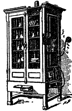
Fig. 99. — Etuvă pentru cultură microbiană (încălzită prin tuburi prin cari trece aer cald).
