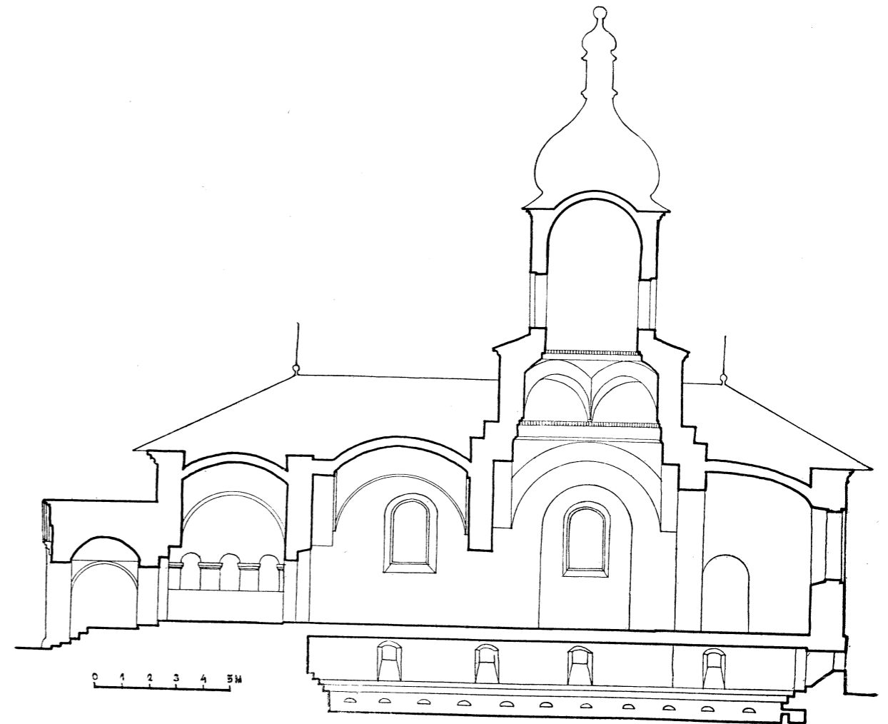
Fig. 71. Biserica Sf. Ion Bogoslov. Secțiune longitudinală
