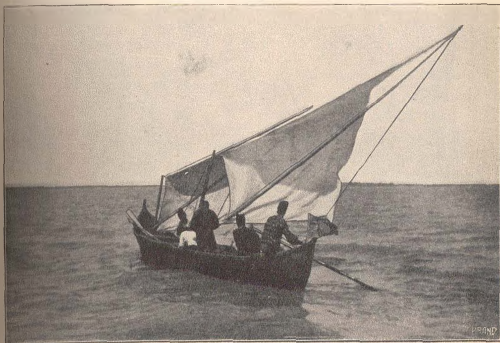
Fig. 241. O lotcă mare din Deltă mergând cu pânzele; arată modul cum se pun catargele, ghionderele și pânzele.
