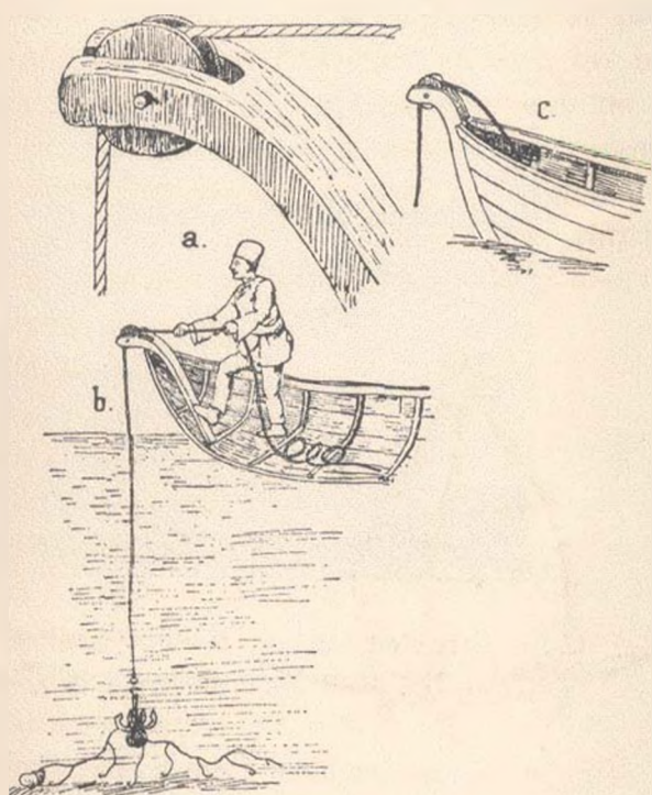
Fig. 158. Scoaterea parilor dela carmace din fundul Dunărei și uneltele ce servesc la acest scop.
